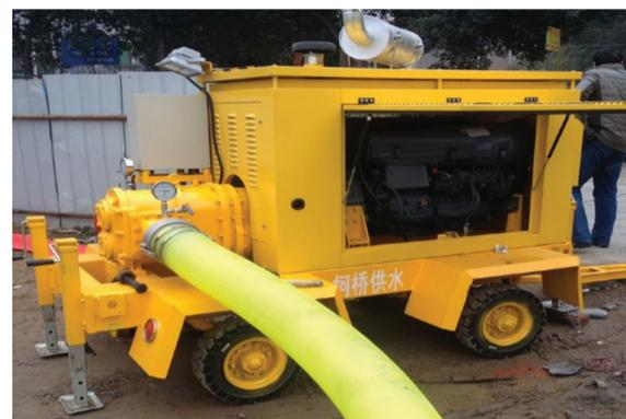
山区管道冲洗移动式泵站
